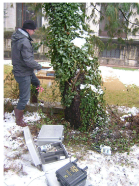
Immagine Nr. 03: prova strumentale di trazione SIM
