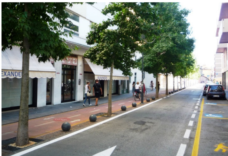
Fig. 29.5 Esempio di pista ciclabile in sede propria separata da sequenza di paracarri e alberi
