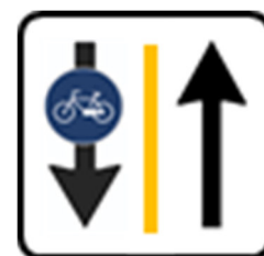
Figg. 29.8 Segnaletica verticale per pista ciclabile con corsia riservata in direzione opposta a quella degli altri veicoli
