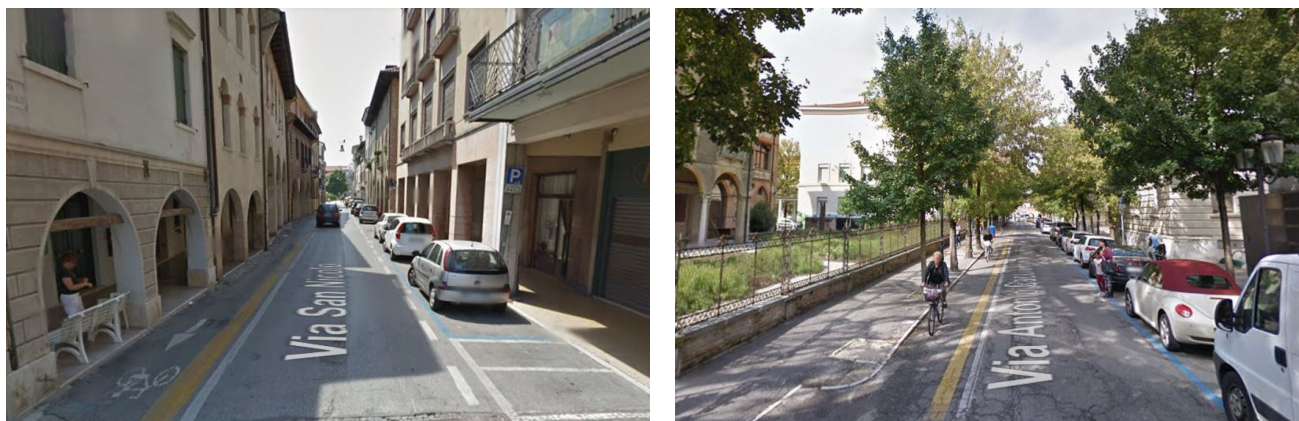
Figg. 29.9 Esempi di pista ciclabile con corsia riservata in direzione opposta a quella degli altri veicoli
