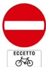
Figg. 29.8 Segnaletica verticale per pista ciclabile con corsia riservata in direzione opposta a quella degli altri veicoli
