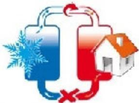
Tali impianti vengono utilizzati per il riscaldamento, se il calore viene portato dall'esterno all'interno, o per il raffrescamento, nel caso in cui il calore segua la direzione contraria, ovvero dall'interno all'esterno.
