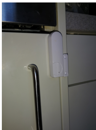
Immagine 4.1.6 Il rilevatore di mancata apertura del frigorifero
