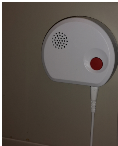
Immagine 4.1.4 Il rilevatore di allagamento
